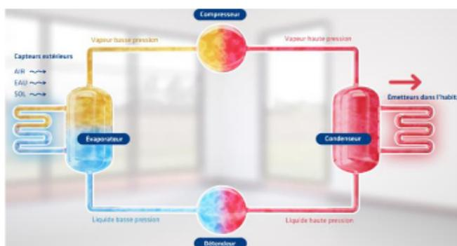
La pompe à chaleur récupère l'énergie dans le milieu extérieur grâce à l'évaporateur, elle fait monter le niveau de la température de l'énergie thermique grâce au compresseur puis elle transfère cette énergie à la bonne température à l'intérieur. Elle est un moyen pour capter et produire de la chaleur à partir de l'énergie gratuite puisée dans l'environnement, mais aussi rafraîchir votre logement en été (on parle de système réversible) et de fournir l'eau chaude sanitaire pour toute la maison !
